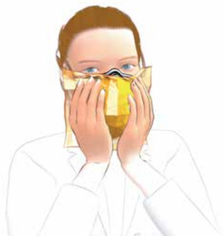
(Test d'étanchéité à pression négative)
