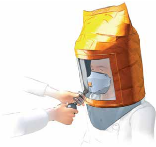
(Essai d'ajustement qualitatif)
