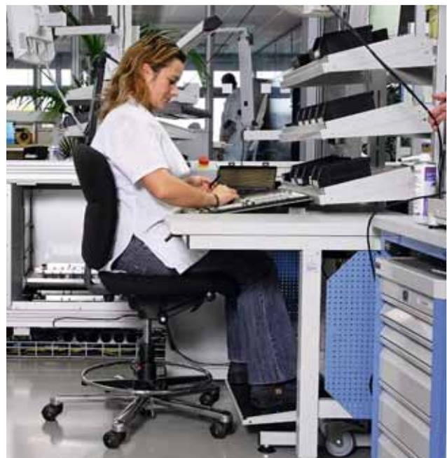
Fig. 10 et 11: les postes de travail doivent permettre d'alterner les positions assise et debout, comme ici pour le montage de précision.
